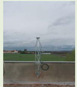
tos con precisión centimétrica y en tiempo real (RTK) en cualquier punto de la comunidad con la utilización de sólo un equipo GPS.
