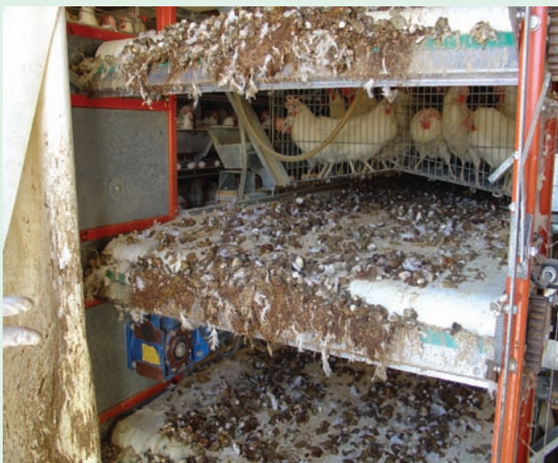
Detalle de la cinta transportadora de gallinaza en una nave de gallinas ponedoras. Detail of the hen droppings conveyor belt in a laying hen house.
