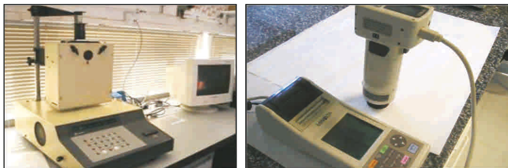
Fig.2.29 Colorímetro Hunter (izq) y Minolta CR-400 (dcha).
