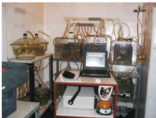
Fig.3.26 Cromatógrafo de gases portátil para la medida de la respiración.
